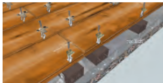
3. Befestigung eines Dielenstoßes in der Fläche
